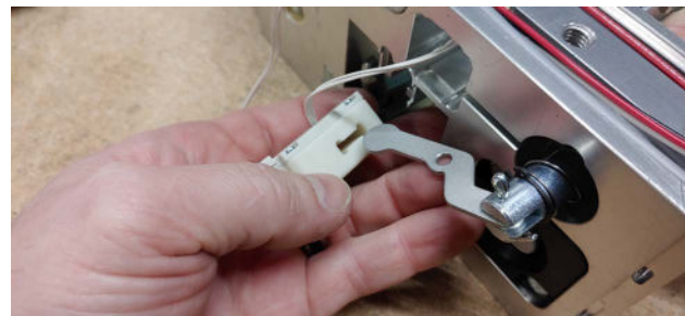
12 Alignez le levier avec le plongeur du solénoïde dans la fente du loquet de positionnement. Figure 71
