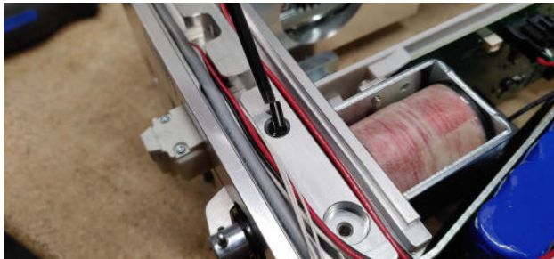
8 Tirez le loquet avec le plongeur du solénoïde. Figure 67
