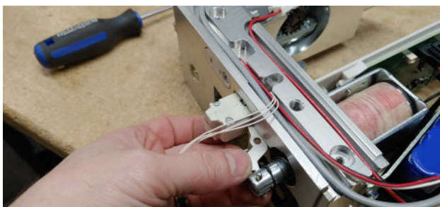
9 Portez une attention particulière au fil et au connecteur lorsque vous enlevez le loquet de positionnement. Figure 68
