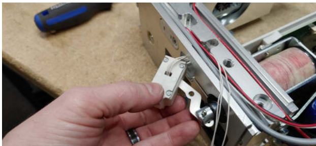
9 Portez une attention particulière au fil et au connecteur lorsque vous enlevez le loquet de positionnement. Figure 68
