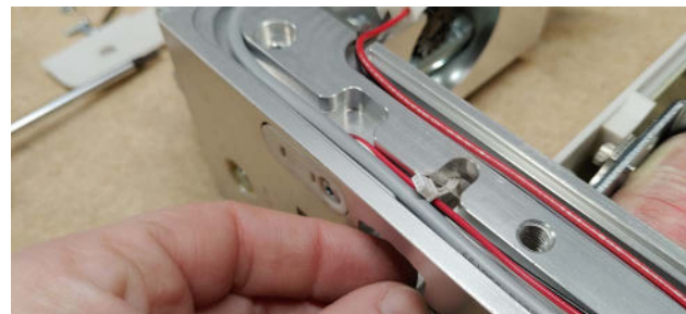
12 Alignez le levier avec le plongeur du solénoïde dans la fente du loquet de positionnement. Figure 71
