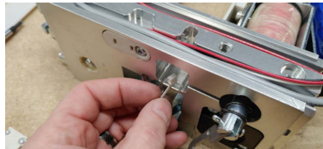
11 Passez le connecteur dans le trou. Figure 70
