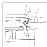
Bloccare le ruote di ReTurn. Accertarsi che il utente sia sicuro in posizione eretta di fronte a ReTurn per poter sganciare l'imbracatura. Sganciare e rimuovere l'imbracatura da ReTurn.
