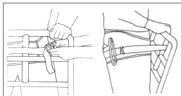
Ne pas fixer la boucle de fermeture sur ReTurnBelt avant de relever la personne. Une fois que la personne est debout face à ReTurn, la boucle de fermeture peut être placée autour de l'une des poignées verticales de l'échelle.
