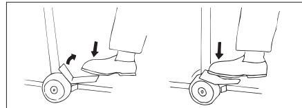
Jedes Rad ist mit Bremse versehen. Treten Sie auf die rote Kennzeichnung der Fußbedienung und achten Sie darauf, dass sie bis zum Anschlag getreten werden muss.
