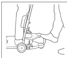
Leggstøtten justeres slik at den øvre kanten på platen ligger ca 3 cm/to fingre under kneskålens nedre kant/leddspalten. Trekk ut splintene for å løsne og justere til passende høyde.
