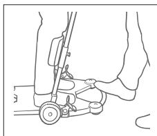
Underbensstödet justeras in så att övre kanten av plattan ligger ca 3 cm/två fingrar under knäskålens nedre kant/ledspringan. Drag i de två sprintarna för att lossa, justera till lämplig höjd.
