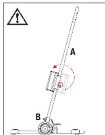
A. Rahmen/Rohr so in das Untergestell einsetzen, dass die Höhenverstellungsknöpfe auf der Seite der Hilfsperson zu liegen kommen.
