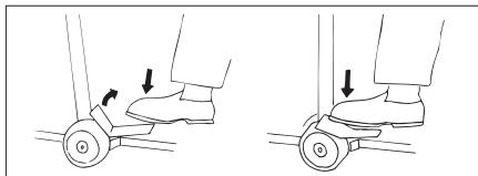
Det finns en broms för vardera hjul. Trampa på bromsplattans röda markering, se till att du trampat ner dem i botten.
