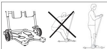
Das Untergestell entsprechend der Kennzeichnung auf der Bodenplatte betreten.
