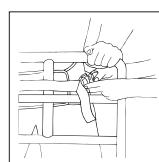
Freiner les roues de ReTurn. Pencher l'utilisateur vers l'avant de sorte que la sangle de blocage se détende. Ouvrir la boucle et retirer la sangle de ReTurn, la replier sous le bord de la ceinture, de sorte qu'elle ne se bloque nulle part. Descendre en position assise en l'aïdant avec ReTurnBelt.
