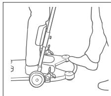
Die Unterschenkelstütze ist so einzustellen, dass die Oberkante der Stützschale etwa 3 cm/2 Finger breit unter der Unterkante der Kniescheibe/Gelenkspalte zu liegen kommt. Zum Lösen die beiden Sperrknöpfe herausziehen und richtige Höhe einstellen.
