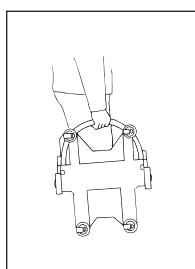
Le châssis et la poignée en forme d'échelle peuvent être portés séparément. Porter le châssis par le tube qui est placé dans la partie avant du produit.
