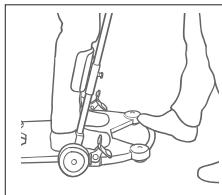
La plaque d'appui des tibias se règle de sorte que le rebord supérieur de la plaque soit à environ 3 cm (à deux doigts) en dessous du bord inférieur de la rotule. Tirer sur les deux goupilles pour libérer les plaques, puis ajuster à la hauteur correcte.
