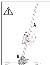
A. Håndtagsstigen/røret trykkes ned i fæstet på chassiset, så højdejusteringsknapperne er monterede mod hjælperens side.
