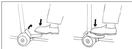
Det finnes en brems for hvert hjul. Tråkk på bremseplatens røde markering, og tråkk den ned i bunnen.
