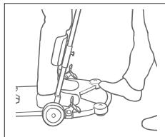
Regolare il supporto gambe in modo tale che la parte superiore si trovi a circa 3 cm (o due dita) sotto le rotule. Tirare i due pin per allentare. Regolare l'altezza in base alle esigenze.
