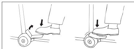
Der er en bremse på hvert hjul. Træd på bremsepladens røde markering; sørg for, at du træder dem ned i bunden.
