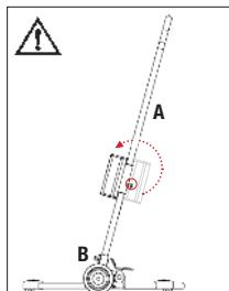
A. Handtagsstegen/röret trycks ned i fästet på chassiet så att höjdjusteringsknapparna är monterade mot medhjälparens sida.
