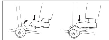
Ogni ruota è dotata di un freno. Con il piede, premere la leva del freno indicata da un simbolo rosso. Premerla fino in fondo.
