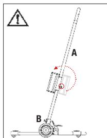
A. Enfoncer la poignée en forme d'échelle dans sa fixation sur le châssis, de sorte que les boutons de réglage en hauteur soient montés face à l'assistant.
