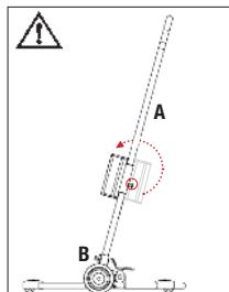
A. Encaje el tubo/escalera de ascenso en las fijaciones de montaje del chasis de modo que los botones de ajuste vertical queden orientados hacia el asistente.
