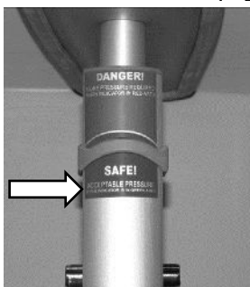
Figure 19 : Manomètre dans la zone de sécurité
