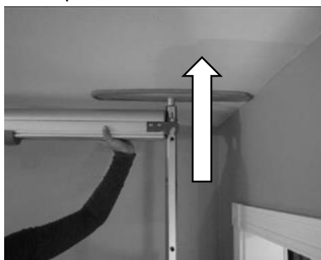
Figure 33 : Lever pour décrocher le rail
