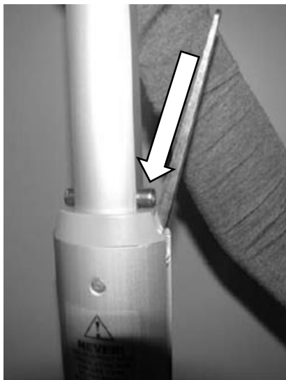
Figure 41 : La goupille inférieure touche le couvercle en plastique
