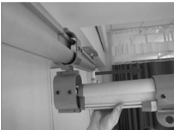
Figure 31 : Enlever la glissière transversale du chariot
