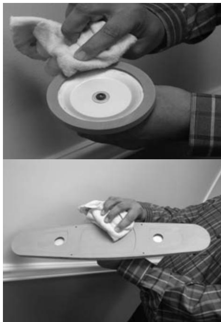
Figure 45 : Essuyer les pieds en caoutchouc inférieurs (à gauche) et supérieurs (à droite)
