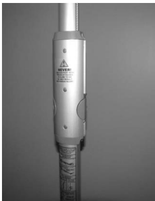
Figure 43 : Levier et le verrou de sécurité à leur position d'origine
