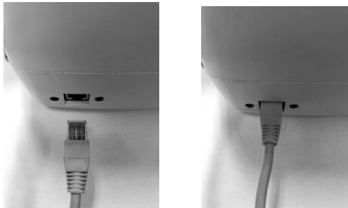
Illustration 3 : Connecteur de la commande manuelle avec la languette de verrouillage insérée à l'intérieur du connecteur du lève-personne
