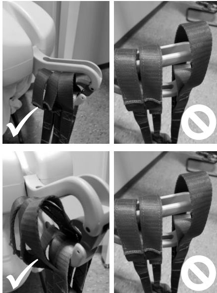
Illustration 10 : Sangles de l'élingue placées correctement et incorrectement
