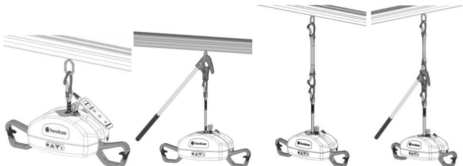
Illustration 9 : supérieur gauche – raccord standard. Supérieur droit – raccord bras rallonge. Inférieur gauche – raccord courroie. Inférieur droit – raccord bras rallonge et courroie.
